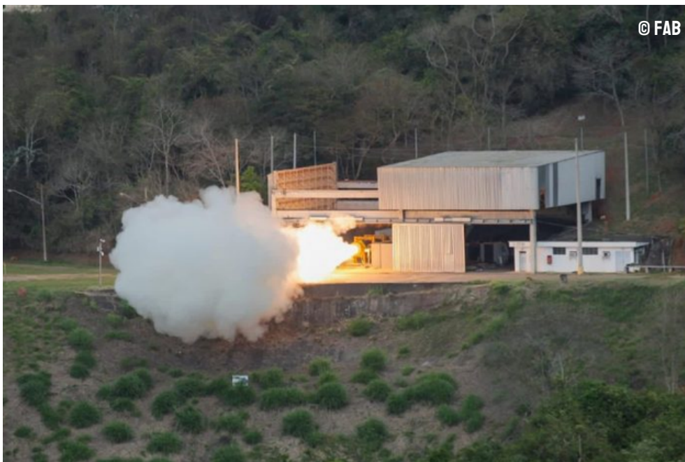
IMAGEM DO PRIMEIRO ENSAIO DE TIRO EM BANCO DO MOTOR-FOGUETE S50
